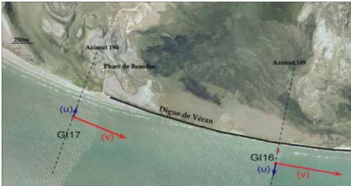
Figure III 35 : Orientation des composantes dominantes longitudinales (V) et transversales (U) de courant au dessus des deux ADCP
