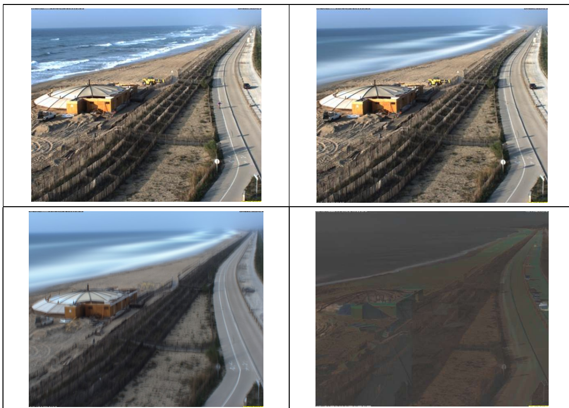
Illustration 8 - Types d'images collectées : image instantanée (en haut à gauche), image moyennée sur dix minutes (en haut à droite), image moyennée sur la journée(en bas à gauche) et image variance (en bas à droite).
