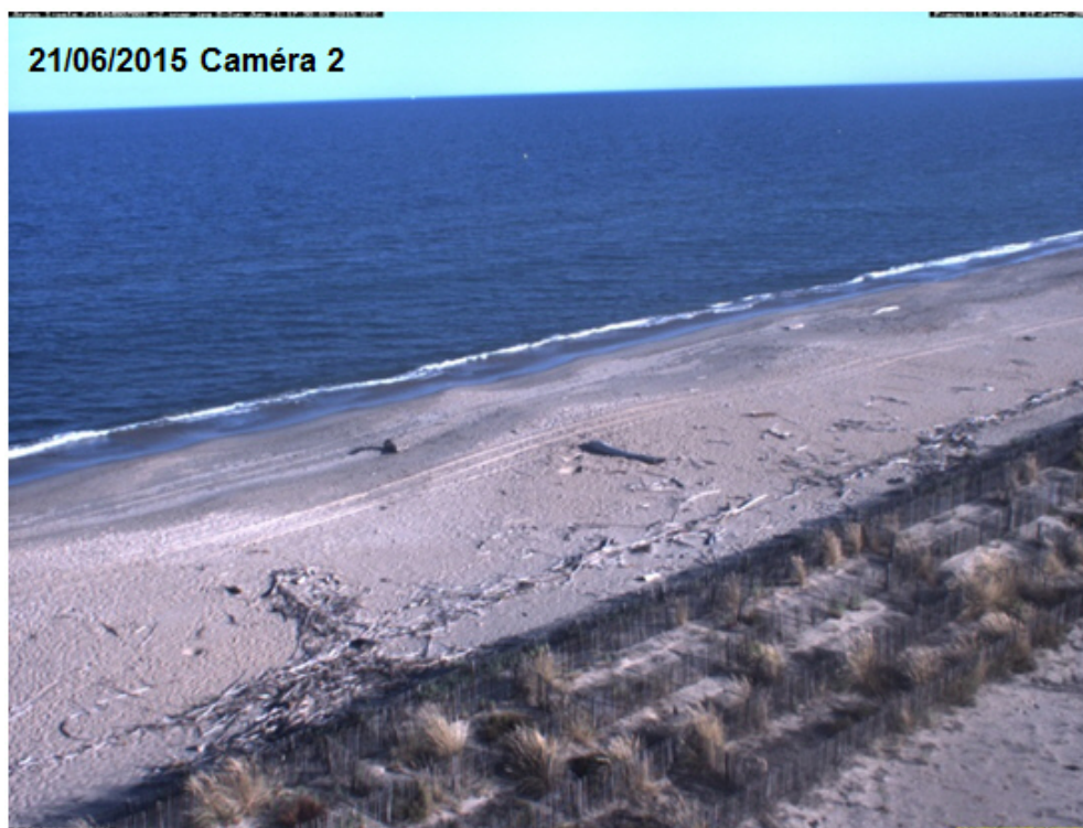
Illustration 46 – Image oblique de la caméra C2 le 21 juin 2015 mettant en évidence la présence de sable rechargé (plus sombre) en bas de plage, à plus de 1 km de la zone rechargée.
