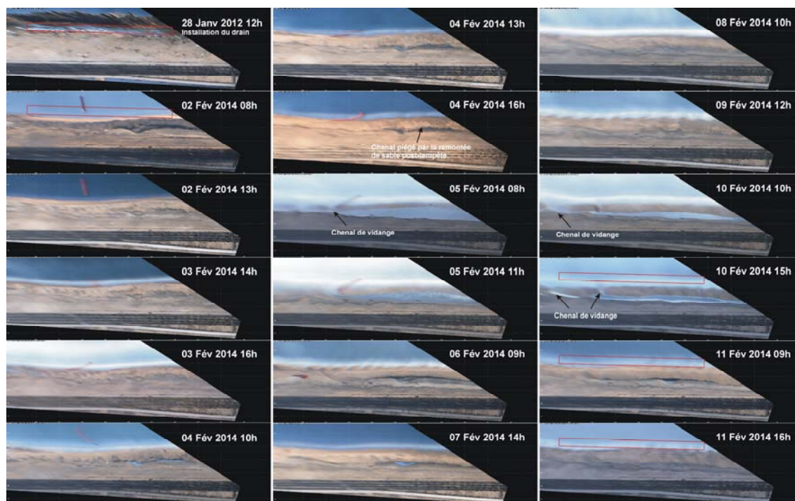
Illustration 14 – Impages orthorectifiées de la Caméra 3 montrant la rupture du drain au NE de la station de pompage. Le rectangle rouge indique la position des drains lors de leur installation en 2012.
