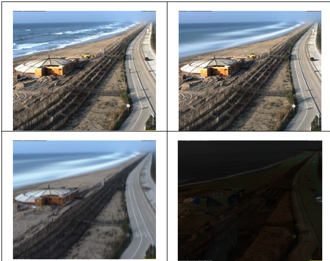
Illustration 6 - Types d'images collectées : image instantanée (en haut à gauche), image moyennée sur dix minutes (en haut à droite), image moyennée sur la journée(en bas à gauche) et image variance (en bas à droite)
