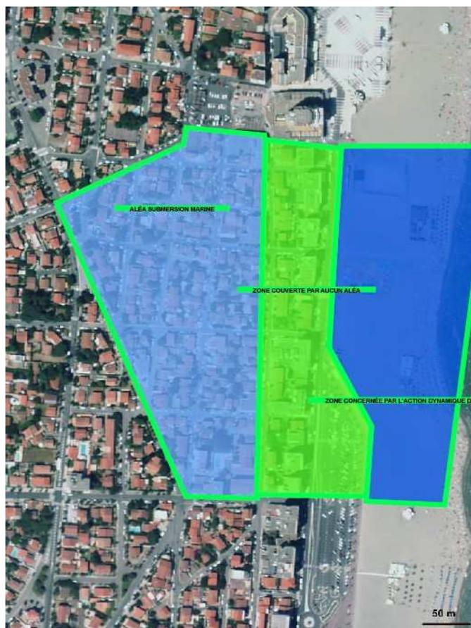
Figure 27: Carte obtenue dans l'onglet « Etats d'inondation » d'Osiris Inondation représentant les différentes catégories d'aléa du PPRi (Osiris Inondation, 2011)
