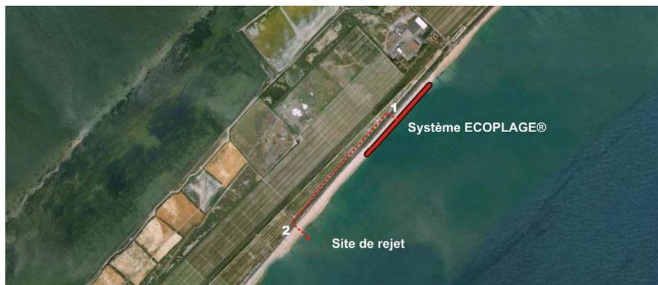
La canalisation de refoulement entre la station de pompage et le point de rejet en mer cheminera sur environ 1 100 m le long de la piste cyclable. La piste cyclable sera donc détruite à un endroit puis reconstituée à l'identique après la mise en place de la canalisation.
