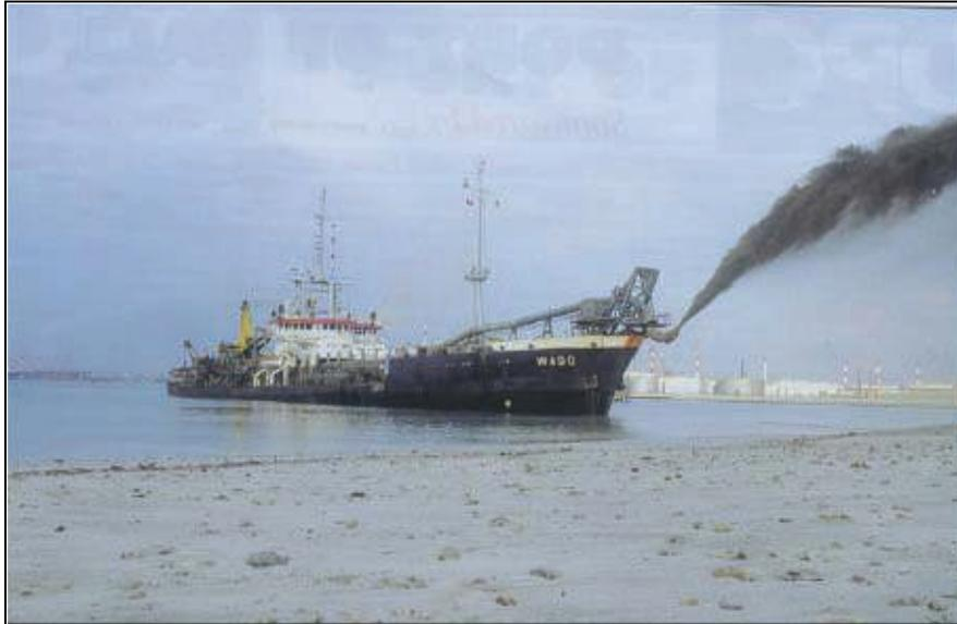
**Figure E.6 : Refoulement par un canon**
